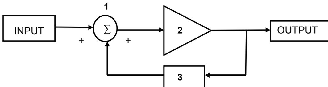
**FIGURE 7.2: BLOCK DIAGRAM OF A FEEDBACK CIRCUIT**
