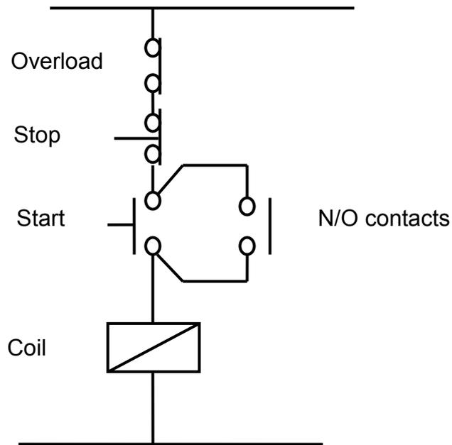
**FIGURE 9.2: CONTROL CIRCUIT**
