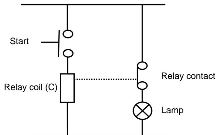
**FIGURE 9.1: RELAY CIRCUIT**
